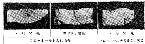
写真-1 疲労破面の代表例
