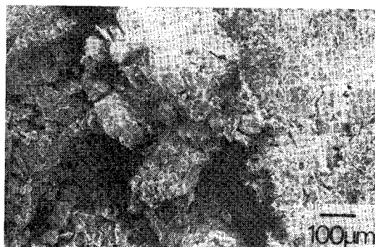
写真-8 粘性土を用いたセメント処理土（添加量：2.5%，材令：1日）の降雨侵食試験後の供試体表面の SEM 像（倍率：100）
