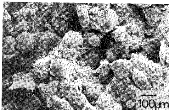
写真-5 砂質土を用いたセメント処理土（添加量：2.5%，材令：1日）の降雨侵食試験後の供試体表面の SEM 像（倍率：100）
