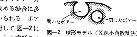
図-2 球形モデル(X線小角散乱法)
