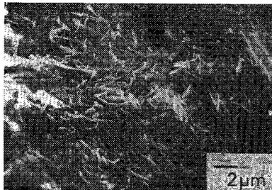
写真—11 セメント-排脱石膏処理土（試料土：粘性土，セメント-石膏(10%-10%)，材令 7 日）の SEM 像
