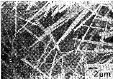
写真—5 消石灰-排脱石膏処理土（試料土：砂質土，添加量：20%，消石灰：石膏（1：1），材令 90 日）の SEM 像
