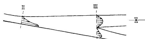
図-9 分岐部の流速分布
