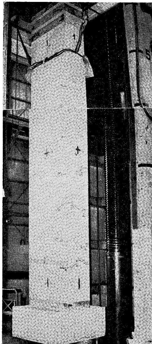
写真-3 合成柱 CO2-e=20 に生じたひびわれ状況
