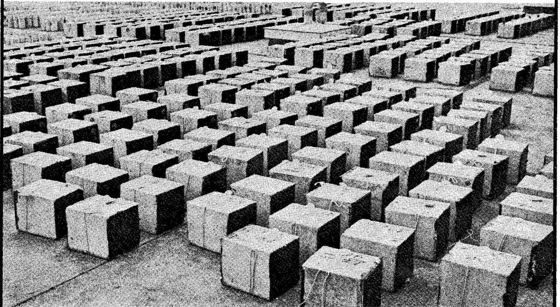
弊社中央研究所における、鉄筋の腐食状態を調べるためのコンクリート屋外暴露状況
