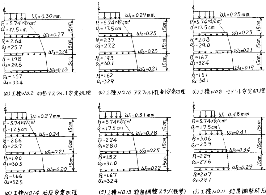
図一〇 各工種の試験舗装における荷重分散の状況
