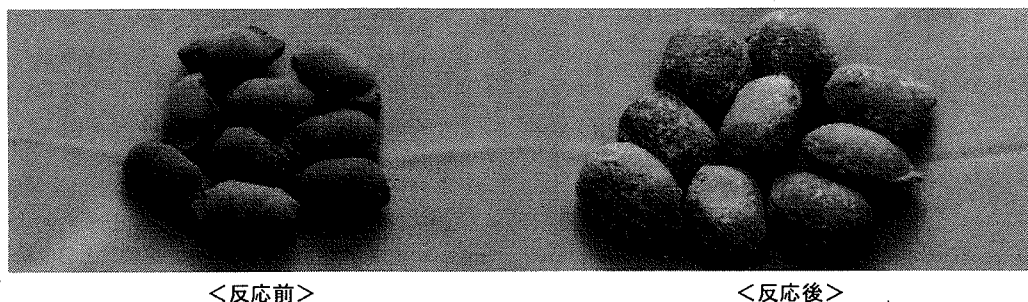
写真-3 造粒プラントによる固粒体(反応前および土中一次混合養生反応後)
