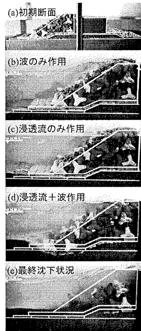
写真-7 地盤の強制的な液状化による消波ブロックの沈下再現実験（小型実験）
