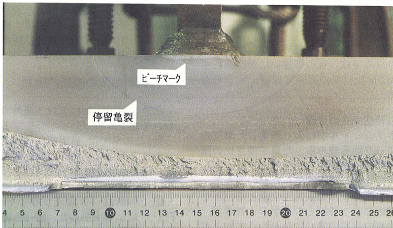
図-3 疲労破壊面と荷重条件 ( t_1=75 mm, t_2=25 mm)
