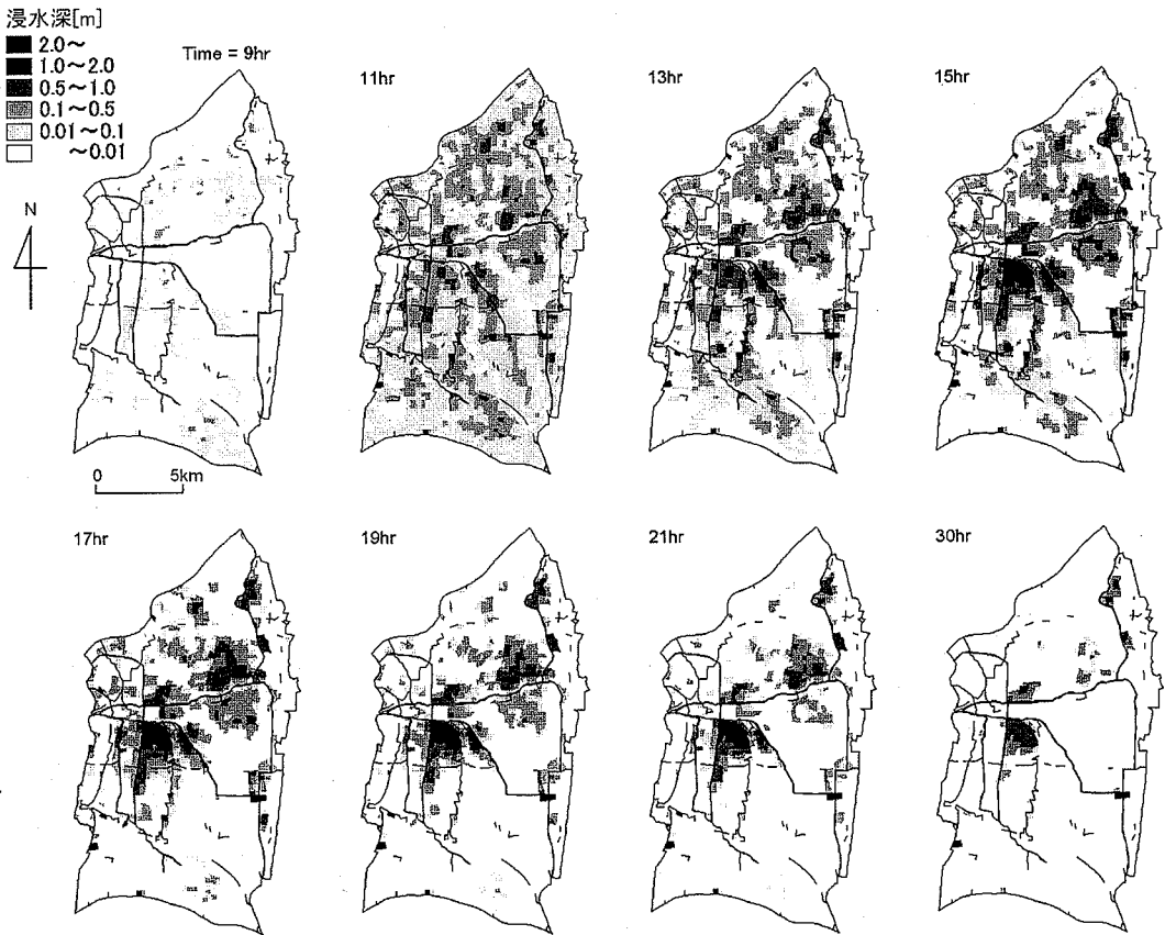
図-13 浸水深の時間変化 (八尾降雨の場合)
