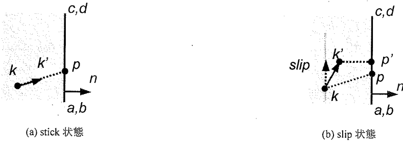
図-22 接触により生じる幾何学的な拘束条件の概念図
