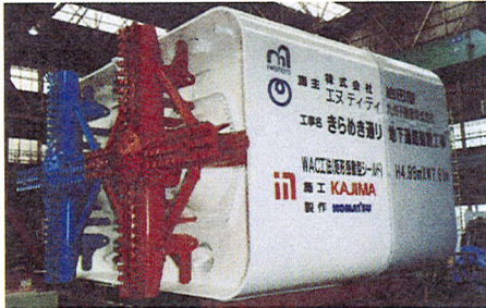
写真-2 揺動式矩形シールド掘削機の全景
