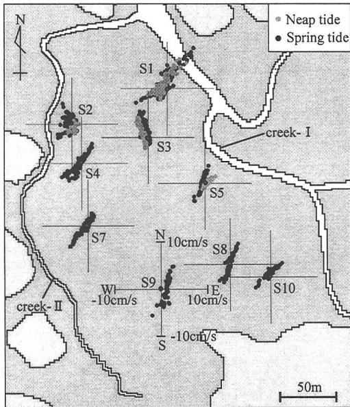
図-11 水平流速プロット
