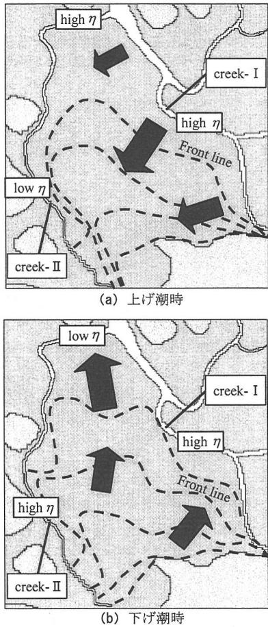
図-23 潮汐フロント（点線）と平面流動パターン（矢印）の模式図（ $\eta$ ：水位）
