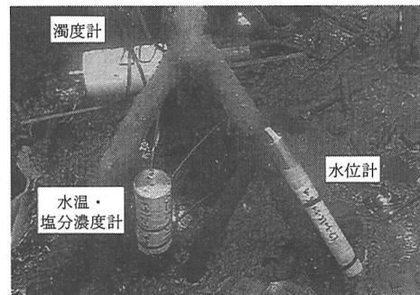
図-5 測定器設置の様子
