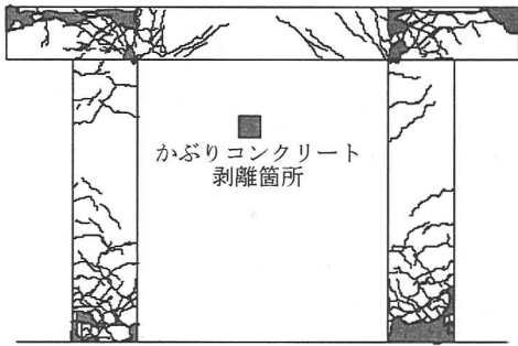
図-9 A-2 供試体 ひび割れ性状
