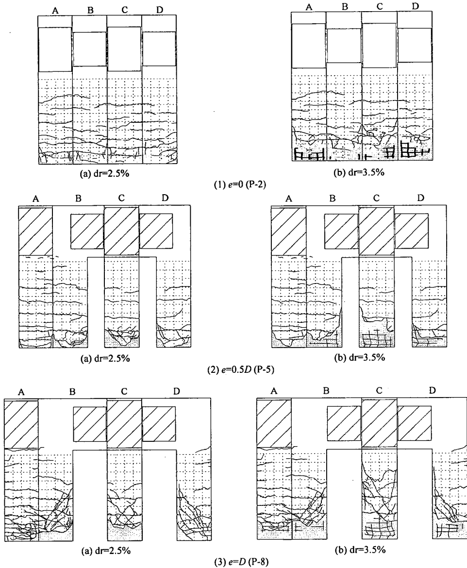
図-14 損傷状況 (矩形載荷した場合)
