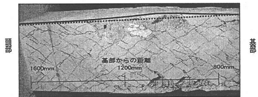
写真-1 供試体破壊状況 (No. 2, \theta = -0.105 rad)
