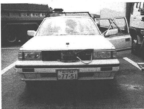
図-2 実験車両(追従車)とレーザー車間距離計
