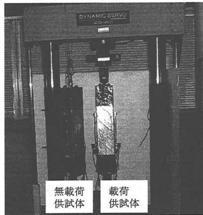
写真-3 一軸引張試験体の載荷状況
