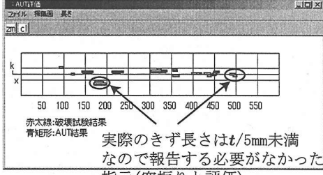
図-15 検出限界寸法以下のきずを報告し、空振りとなった例
