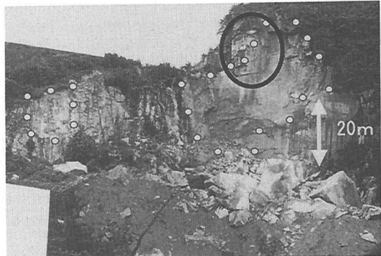
写真-2 崩落後。右側の白丸で囲った範囲が写真-1に対応。黒い楕円形が監視対象の不安定岩塊。
