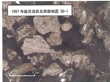
写真-3 1997年鹿児島県北西部地震において海岸埋立地以外で生じた噴砂の内細粒側の噴砂の顕微鏡写真
