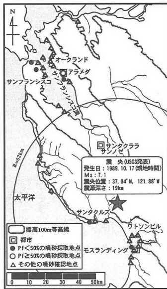
図-4 1989年ロム・ブリエタ地震における噴砂採取地点 20)
