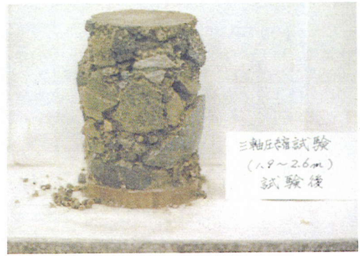
写真一4 試験後の供試体状況 ( \sigma_3=98 kPa)
