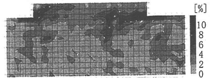
図-26 (f) 上載 6.0kN ひずみ場 載荷点変位 2.4mm
