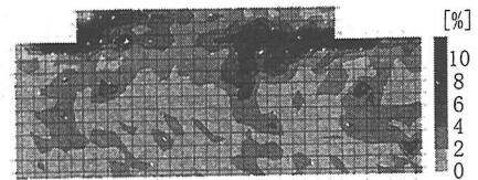
図-27 (g) 上載 6.0kN ひずみ場 載荷点変位 2.8mm
