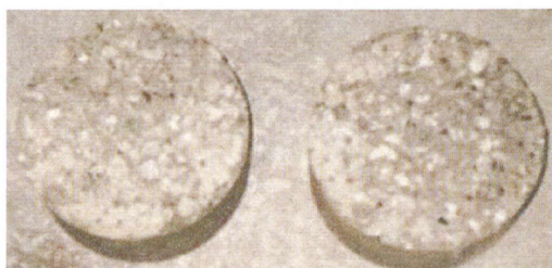
写真-2 せん断面 (超遅延剤使用)
