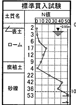
図-16 吹上地区の地盤柱状図
