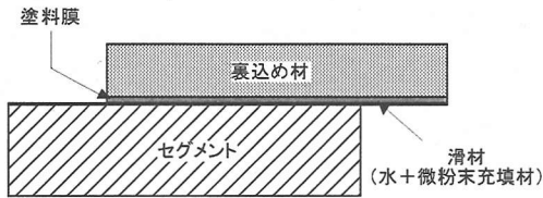
図-13 水性エマルジョン型シリコン系塗料を用いた滑り型免震構造の滑動機構
