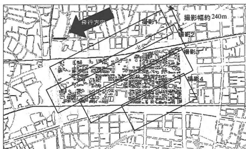
図-3 撮影方法の例 (木造建物の被害判読地域)
