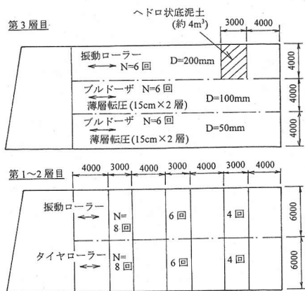
図-1 3 試験盛土各層の試験条件
