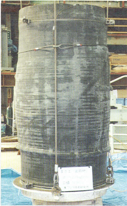
写真-2 拘束圧 \sigma_3=2.0\text{kgf/cm}^2 (0.196MPa)における 超大型三軸圧縮試験後の供試体の状況
