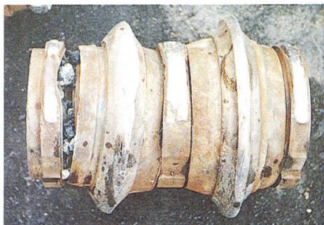
写真-1 デスクカッタの破損状況
