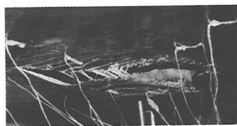
(c) L-7 ガラス繊維シート破断
