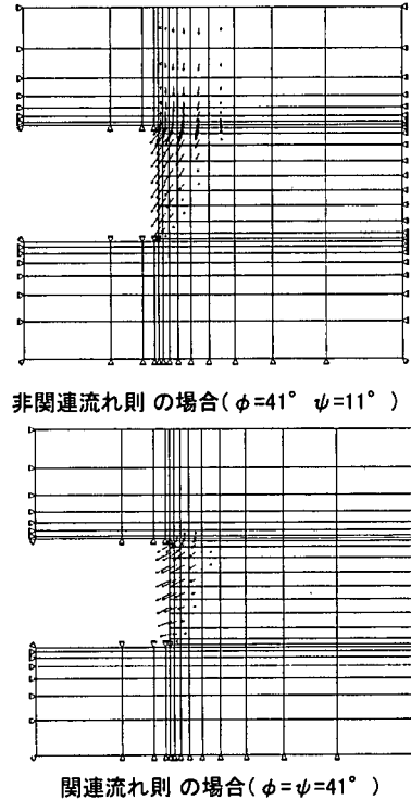
図-8 関連流れ則と非関連流れ則解析結果の比較 (変位速度分布)
