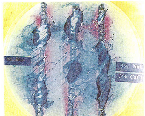
図-6 鋼繊維を混入した場合の鉄筋のアノード部およびカソード部 (10日目)
