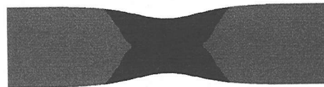
図-6 平面ひずみ状態の分岐経路上での負荷・除荷領域 (負荷：黒色、除荷：灰色) ( w/L=0.2 )
