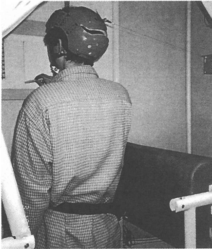
写真-4 頭部および腰部の変位測定
