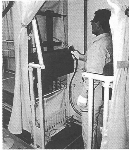
写真-5 溶接作業の限界を求める実験
