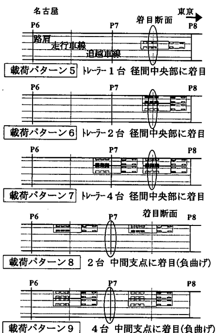
図-4 坂部高架橋試験車両軸重
