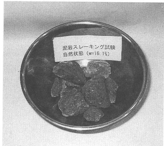
写真-3 (a) 泥岩材のスレーキング試験
