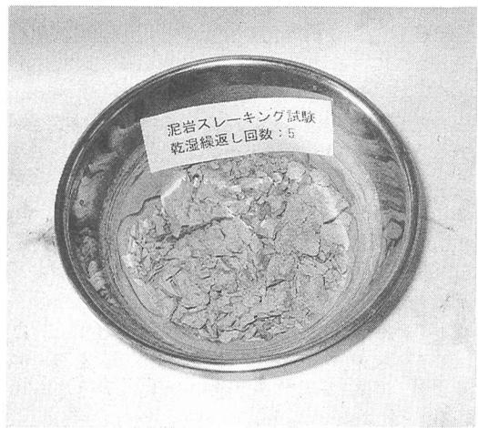
写真-3 (b) 泥岩材のスレーキング試験
