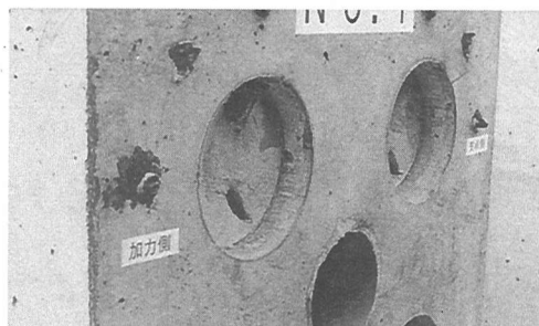
写真-3 鋼管のすべり状況 (B-4T14N)
