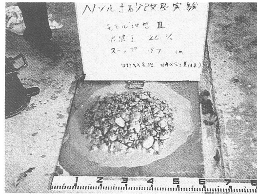
写真-2 加泥材による土性改良 (モデル-III 添加率20%)
