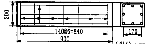
(b) 帯鉄筋ピッチ14cm
