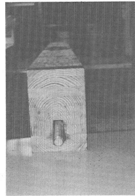
写真-2 PC鋼材を配置した供試体
