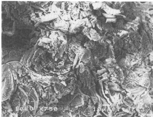
写真-5 等方圧9807kPaを載荷した珪藻土 倍率750倍(—— 10 \mu m)
