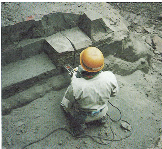
写真-3.1 固結シルトのブロックサンプリング (Tm2)
