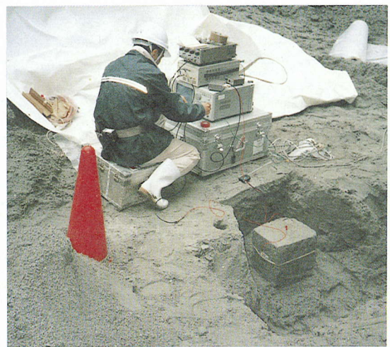
写真-3.2 セン断波速度測定中の砂ブロック (Ts1)
