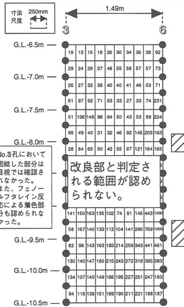
(d)改良範囲の評価結果とボーリング調査結果の比較 (3-6断面)
