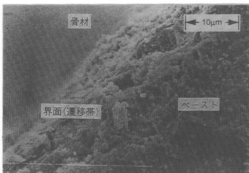
写真-1 硬化体内部の SEM による観察結果
