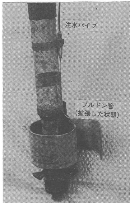
写真一2 リバウンド測定点固定方法
