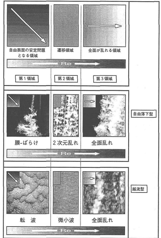
図-1 3 自由落下型と越流型の比較
