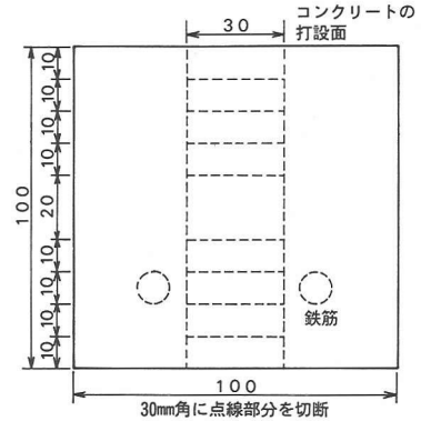
図-4 塩化物分析試料の採取方法 (単位:mm)
